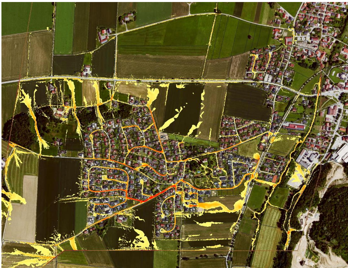
Abb. 8 Maximale Fließgeschwindigkeiten für D60, N100, Überblick Einzugsgebiet
