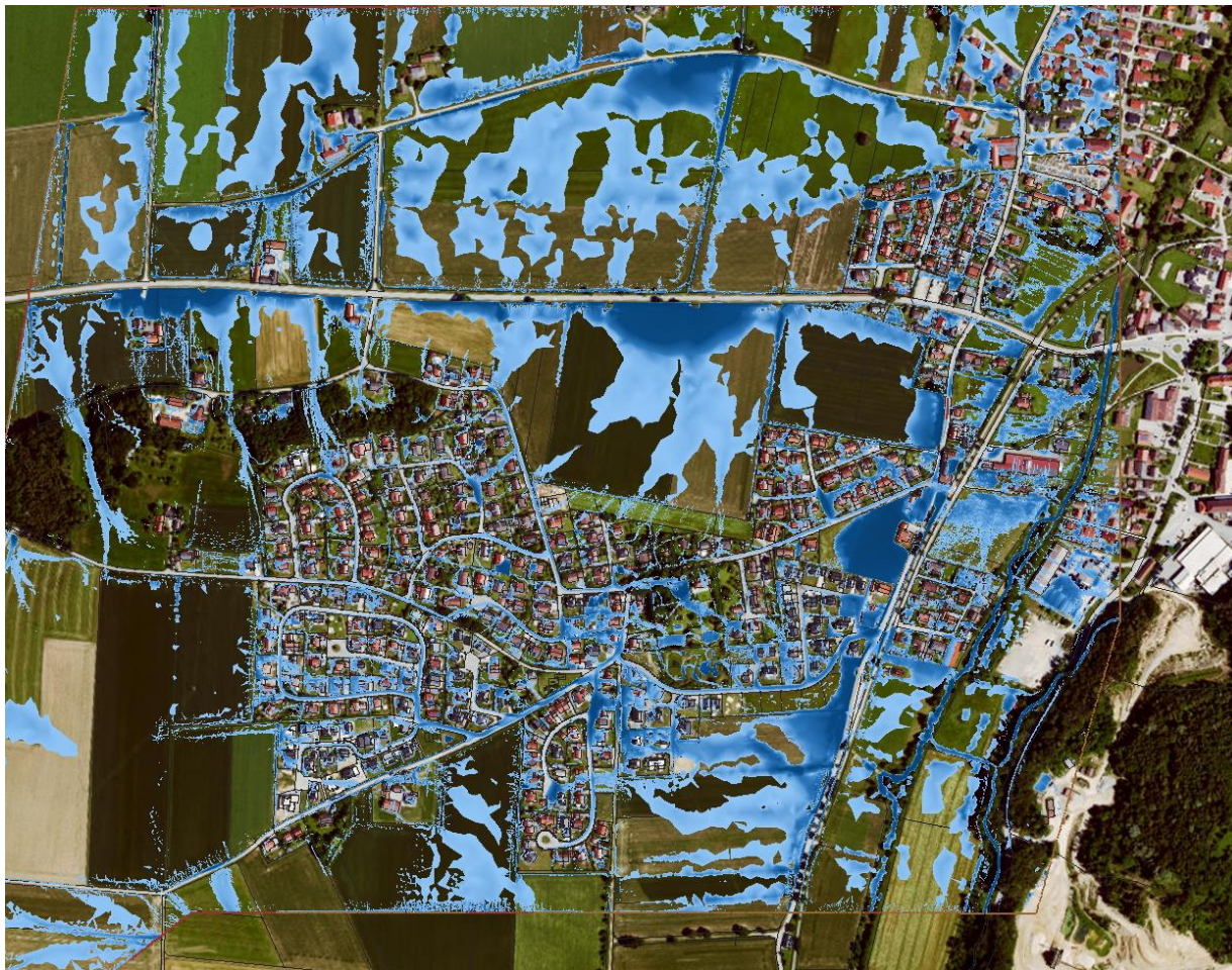
Abb. 6 Maximale Fließtiefen für D60, N100, Überblick Einzugsgebiet
