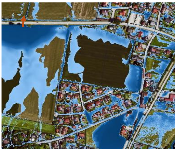
Abb. 7 Maximale Fließtiefen für D60, N100, Ausschnitt Bereich geplantes Vorhaben
