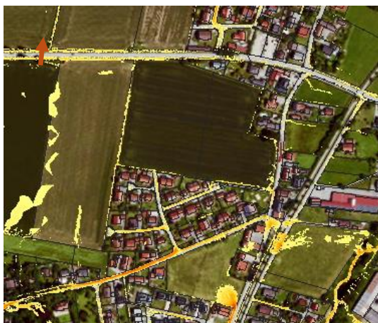
Abb. 9 Maximale Fließgeschwindigkeiten für D60, N100, Ausschnitt Bereich geplantes Vorhaben
